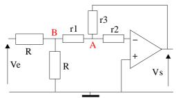
L'amplificateur opérationnel est idéal. Calculer la fonction de transfert  $V_{\rm S}/V_{\rm E}$  du montage en fonction des valeurs des résistances.
