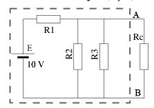
En utilisant le théorème de Thévenin déterminer les équivalents Thévenin et Norton de la partie du circuit contenue dans le cadre en pointillés.
