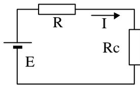
E est un générateur de tension idéal ( $E = 12 \text{ V}$ ) en série avec une résistance interne  $R = 0,01 \Omega$ .
