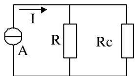
A est un générateur de courant idéal ( $I = 5 \text{ mA}$ ) et R sa résistance interne  $R = 250 \text{ k}\Omega$ .
