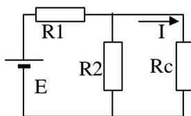
E est un générateur de tension idéal ( $E = 12 \text{ V}$ )
