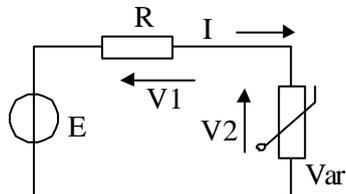
On considère le circuit composé d'une « varistance Var » alimentée par un générateur de f.e.m.  $E = 40 \text{ V}$  en série avec une résistance  $R = 100 \Omega$ . Soit  $V_2$  la tension aux bornes de la varistance. La caractéristique de celle-ci peut être représentée par une équation de la forme :  $I = K \cdot V^n$ . On a mesuré :  $I = 100 \text{ mA}$  pour  $V_2 = 33 \text{ V}$  et  $I' = 300 \text{ mA}$  pour  $V_2' = 45 \text{ V}$ .
