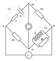
Le pont est alimenté par une tension sinusoï dale. Établir la relation qui existe entre les valeurs  $R_1$ ,  $R_2$ ,  $Z_1$  et  $Z_2$  à l'équilibre du pont.  $Z_2$  est une inductance inconnue que l'on peut modéliser par une inductance pure L en parallèle avec une résistance pure R.
