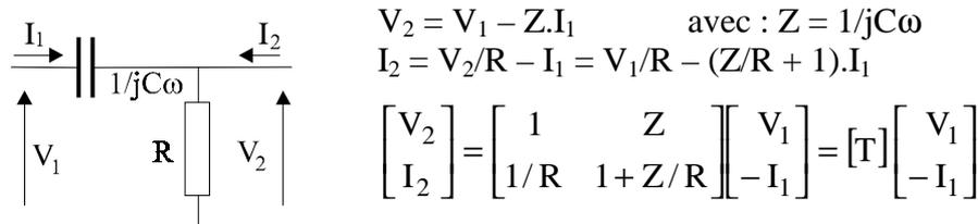
Pour le filtre complet, on obtient :
